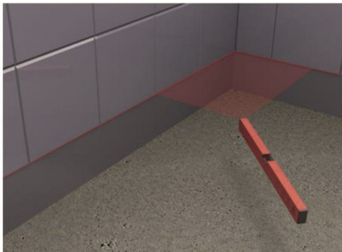
1. Zakreslit rovinu, kde se bude nacházet konečná výška podlahy v místě montáže žlabu. Podlaha by měla být v mírném spádu.
