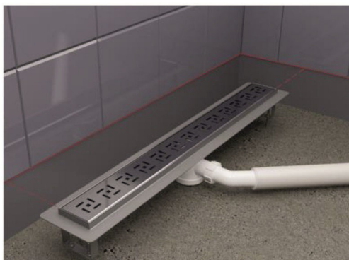
2. Sifon žlabu napojte na kanalizaci. Horní hrana žlabu by měla být asi 1 mm pod určenou výškou konečné podlahy.
